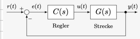
es wird angestrebt, dass geregelt System über weiten Frequenzbereich proportionales Verhalten hat
