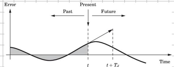
für schwach gedämpfte Strecken (dominante Pole kompl. konj.) lohnt sich D-Anteil da Systemdämpfung des geschlossenen Systems erhöht wird
