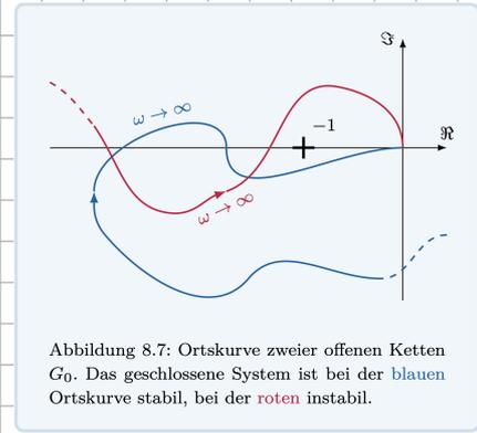
Abbildung 8.7: Ortskurve zweier offenen Ketten  $G_0$ . Das geschlossene System ist bei der **blauen** Ortskurve stabil, bei der **roten** instabil.
