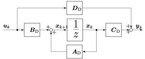
im BSB Integrator durch backward Operator  $\frac{1}{z} = z^{-1}$  ersetzen
