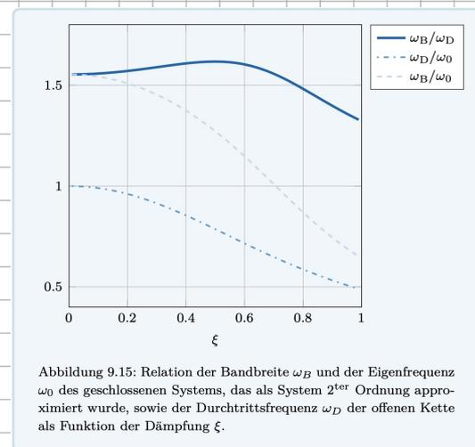
Abbildung 9.15: Relation der Bandbreite  $\omega_B$  und der Eigenfrequenz  $\omega_0$  des geschlossenen Systems, das als System 2ter Ordnung approximiert wurde, sowie der Durchtrittsfrequenz  $\omega_D$  der offenen Kette als Funktion der Dämpfung  $\xi$ .
