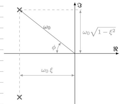
bei Variation des Dämpfungsterms  $\xi$  wandern Pole auf Kreisen um den Ursprung, bei kleinem  $\xi$  laufen sie in Richtung imaginäre Achse, für  $\xi = 1$  treffen sie sich auf der reellen Achse (aperiodischer Grenzfall)
