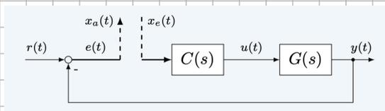
wenn man Kreis bei Regelvorgang auftrifft und  $r(t) \equiv 0$  setzt ergibt sich neuer Eingang  $x_e(t)$  und Ausgang  $x_a(t)$
