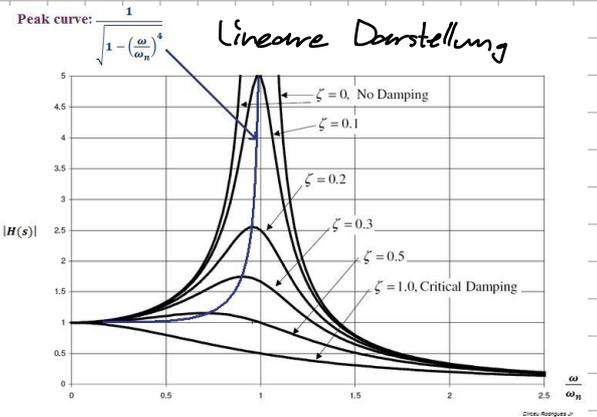
optimaler einfacher die Dämpfung im Phasengang abzulesen!
