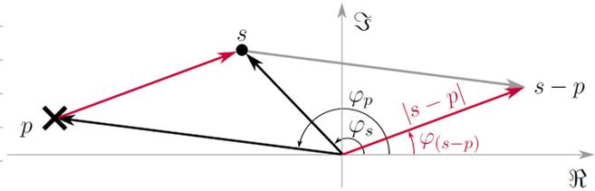
Konstruktionsregeln für positive  $k = 0 \dots \infty$
