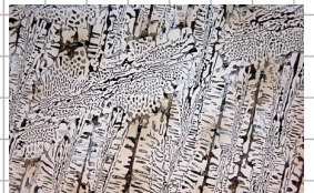
unlegiertes Gusseisen (4.3% C)
