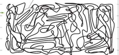
Struktur teilkristalliner Thermoplaste (amorphe und kristalline Bereiche)
