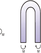
weichgeglüht (10 Stunden bei 700 °C) Perlitlamellen eingeformt (koagulierte) kein Bruch bei einer Verformung von 180°
