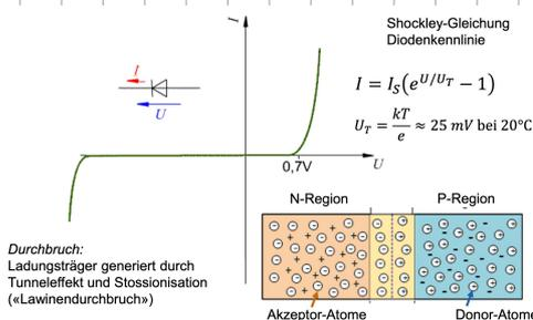
Durchbruch: Ladungsträger generiert durch Tunneleffekt und Stossionisation («Lawindurchbruch»)
