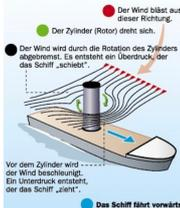
Vor dem Zylinder wird der Wind beschleunigt. Ein Unterdruck entsteht, der das Schiff „zieht“.
