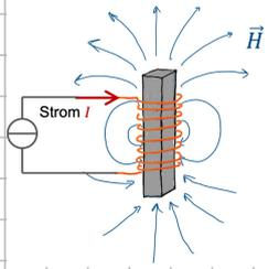
Eisenkern verstärkt und führt das Magnetfeld
